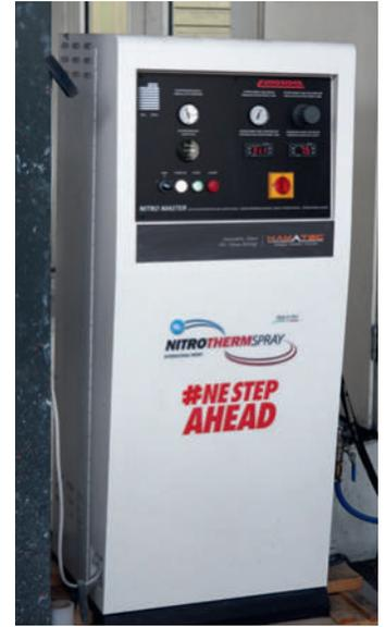
Das System enthält einen Stickstoffpuffer zum Ausgleich von Störungen in der Druckluftzufuhr.
